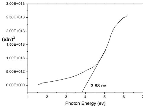
Fig 4  $(ahv)^{1/2}$  Vs  $(hv)$  Optical Band Gap
